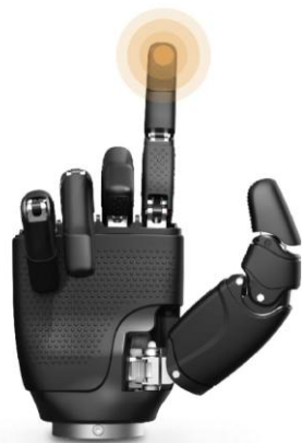
그림 6. 로봇 핸드 촉각센서 감지 활성화 예시
