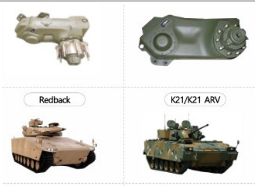
그림 8. 암내장형/Strut형 유기압 현수장치 및 적용 무기
