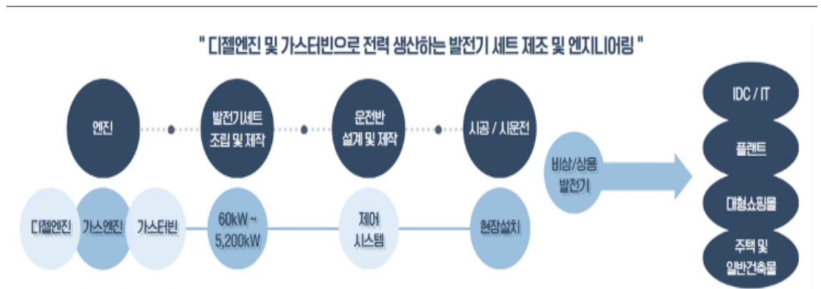
그림 7. 비상발전기 제조·시공 프로세스
