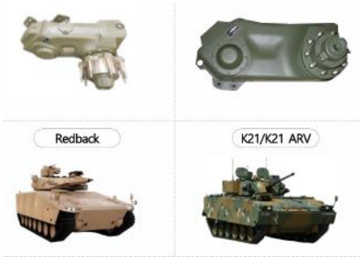
그림 8. 암내장형/Strut형 유기압 현수장치 및 적용 무기
